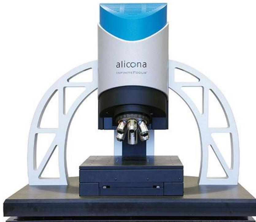
Figura 10. Microscópio de variação de foco – Alicona G5.
